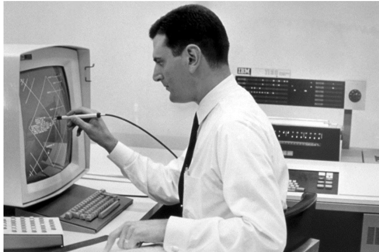
Obrázek 8: Grafický terminál IBM 2250
