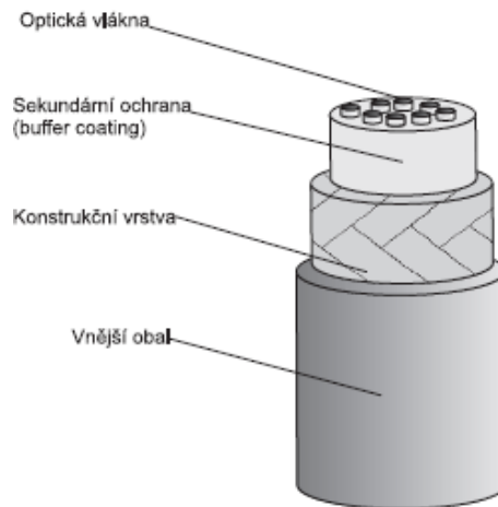
Obr. 13 - Struktura optického kabelu
