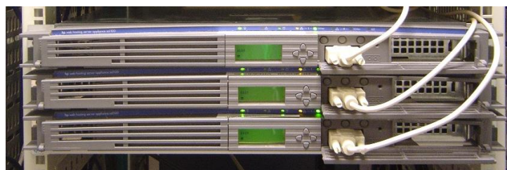
Obr. 4 - Standardizované umístění serverů (velikost 3x 1U ) v racku
