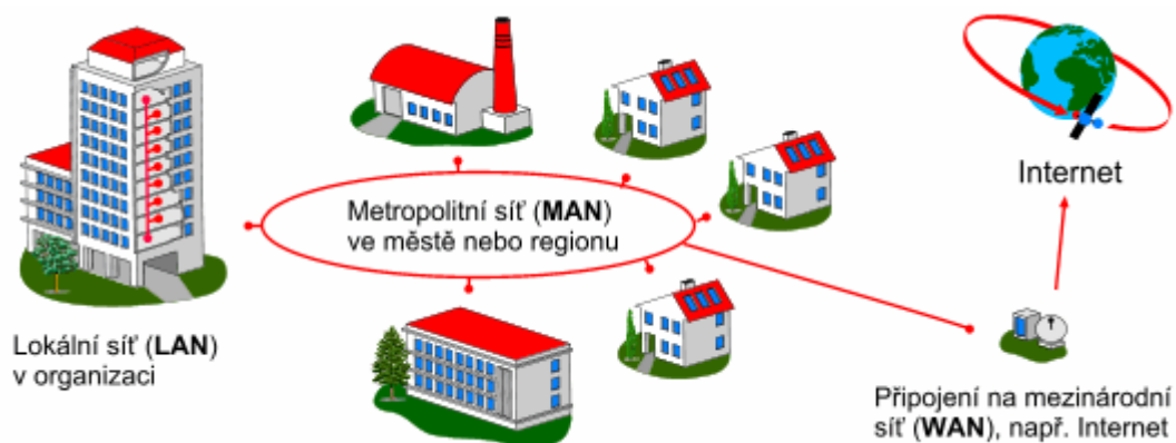
Obr. 1 - Schéma rozdělení počítačových sítí podle velikosti
